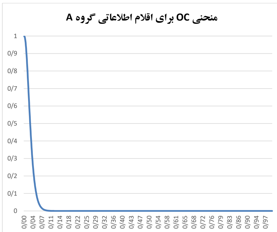
شکل ۳-۵ منحنی OC برای طرح نمونه برداری مشخصه های نوع A
